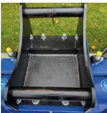
Grävmaskinsfästen välj mellan 0 alt 12 graders lutning
